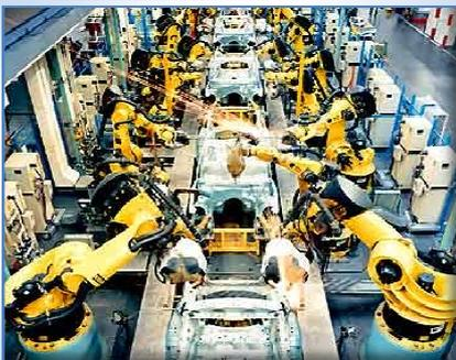
En los procesos de soldadura automatizados, es necesario detectar todas las piezas de carga de proceso antes de iniciar el ciclo de la máquina.
