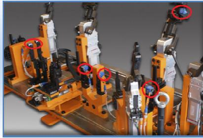
En el proceso de soldadura, es necesario asegurar el correcto posicionamiento de las piezas. En muchos casos, las piezas a montar son de un tamaño reducido o de espesores de milímetros, por lo que es necesario montar detectores que nos aporten dicha precisión a la hora de la detección del correcto montaje o presencia de la pieza. Esto implica utilizar detectores de precisión.
