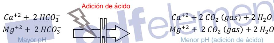
**FIGURA 10:** Neutralización de bicarbonatos con la adición de ácido (para el entorno de pH 7 – 8,5)
