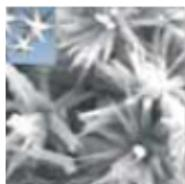
**FIGURA 01:** Cristalización de la cal espontánea sin tratamiento, en estructura adherente e incrustante.
