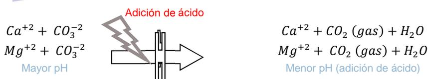
**FIGURA 11:** Neutralización de carbonatos con la adición de ácido (para el entorno de pH > 8,5)
